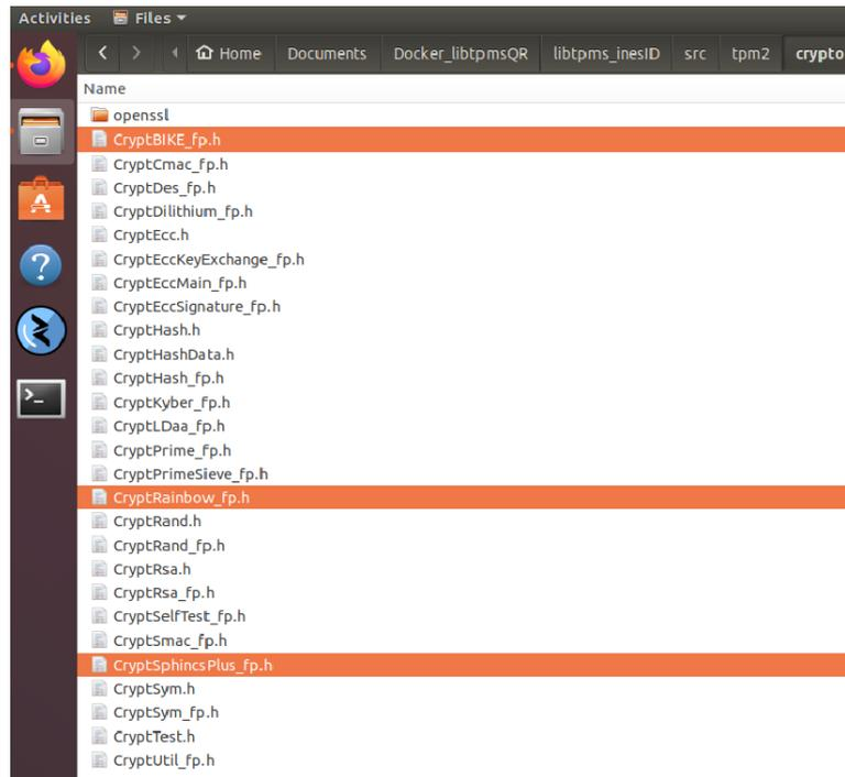
Figure 28: CryptSphincsPlus\_fp.h, CryptRainbow\_fp.h and CryptBIKE\_fp.h Copied Into QR-Libtpms
